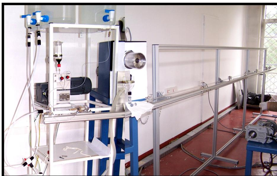
*Figure IV- 44: Vue globale de la ligne continue de filage par coagulation pour l'obtention de la pré-fibre de nanotubes de carbone.*
