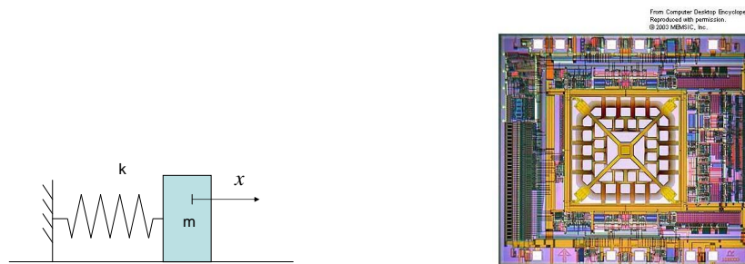
Figure 2.6 – (gauche) Principe de l'accéléromètre, (droite) Exemple d'accéléromètre MEMS (MEMSIC Inc)
