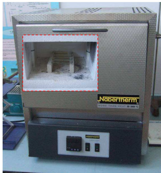
Fig.4 : Four à moufle de l'Institut Prisme de Chartres, les échantillons sont isolés des parois par des supports en céramique afin d'obtenir une cuisson homogène.
