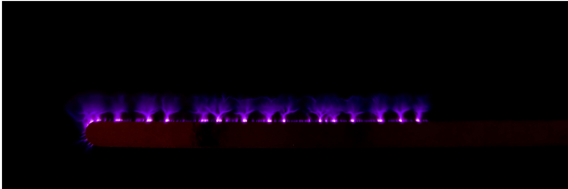
(a) Régime « spots », 6 kV à 1 kHz (20 s, F/4, ISO-200)
