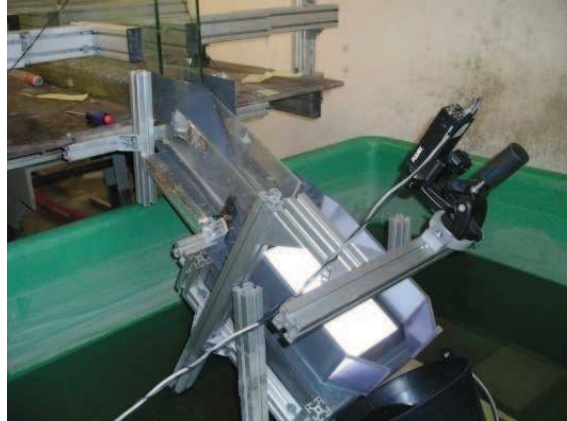
Figure 29 : Dispositif GDS et seuil pour la récupération du matériau en sortie du canal.
