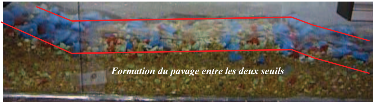
Figure 56 : Formation du pavage entre deux seuils en cascade, associés à une phase d'aggradation du lit.
