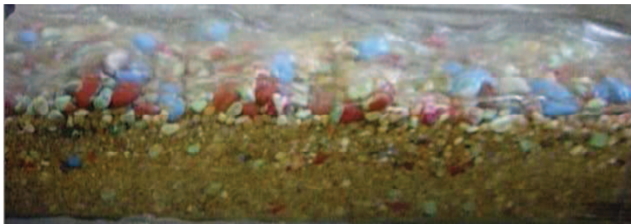
Figure 111 : Expérience avec seuils ; états du lit observés périodiquement pour chaque secteur du canal.
