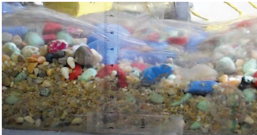
Figure 78 : Exemple de structure step-pool observé dans l'expérience « Fort Transport »
