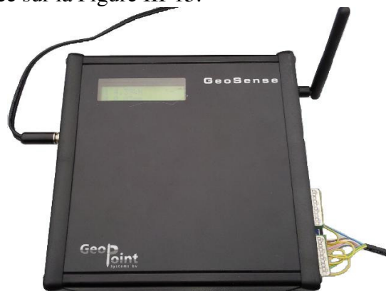
Figure III-13. Enregistreur des données (Data-logger)
