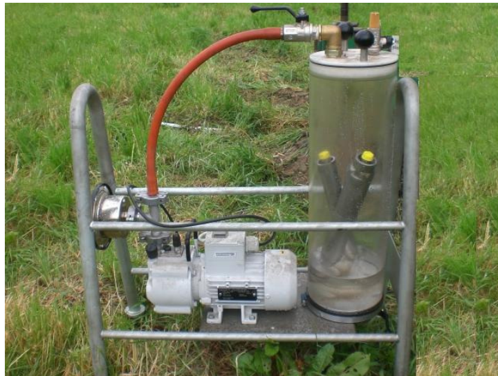
Figure III-5. Système de saturation de la pointe
