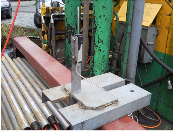
Figure III-6. Capteur de déplacement de la pointe
