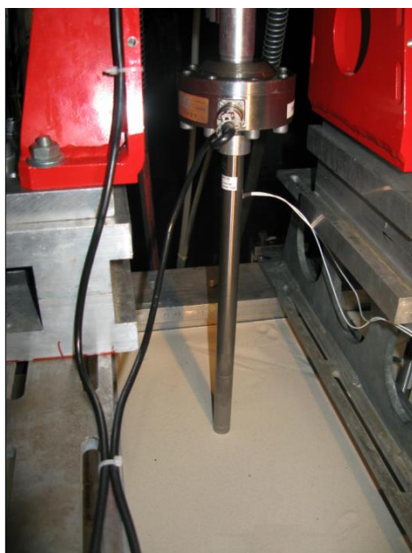
Figure VI-24. Fonçage de la pointe de 20 mm avec le servo-vérin SV_2
