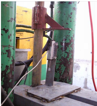
Figure III-8. Système de mesure du déplacement
