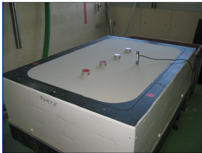
Figure VI-18. Le conteneur CT 2 après la phase de pluviation
