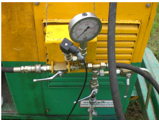
Figure III-12. Capteur de poussée totale en tête
