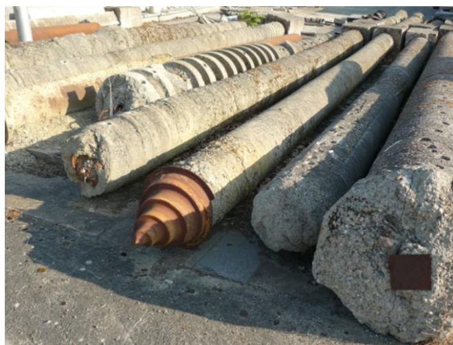
Figure VII-14. Quelques pieux vissés dans le site de Limelette après leur excavation
