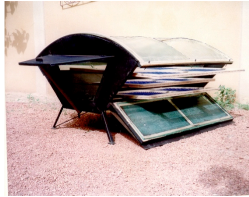
Séchoir solaire à tunnel du CEAS-BF
