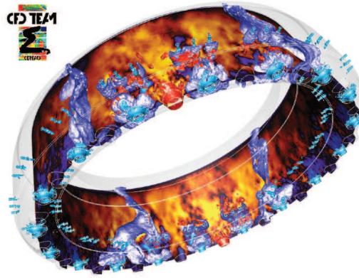
FIGURE 1 – Exemple de simulation LES d’une véritable chambre de combustion d’hélicoptère SAFRAN-Turbomeca, réalisée par Boileau et al. [11]
