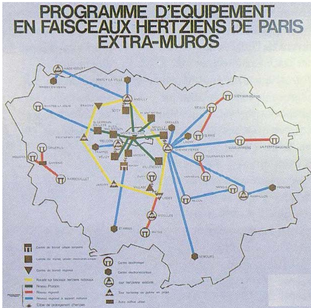
Figure 30 : Extrait du Tableau de bord, Delta LP , en 1974 : Réseau de faisceaux hertziens en Région Parisienne
