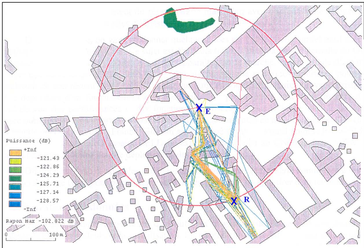
Figure 97 : Lancers de rayons en environnement urbain dense avec le modèle RAYON-CNET
