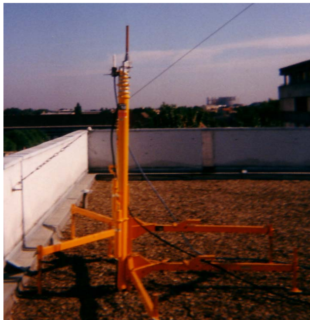
Figure 1.4 : Exemple d'antenne omnidirectionnelle implantée au dessus d'un toit d'immeuble (Préfecture du Bas-Rhin) lors de la campagne de mesure radio COST-CNET2
