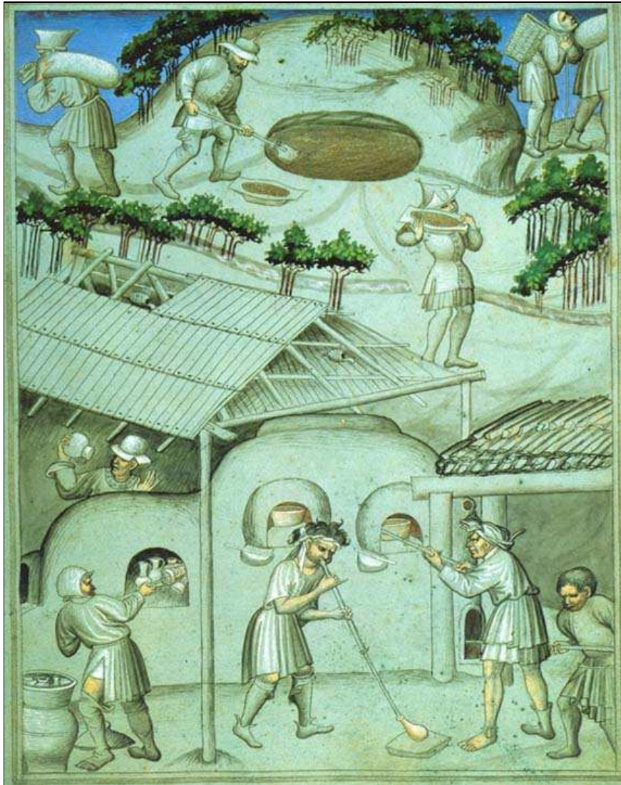
Fig. 24. Verrerie médiévale installée en pleine forêt, le four est protégé des intempéries par des toits en auvents bâtis en planches et en rondins. Le foyer, sans doute un long couloir étroit, alimente d'abord le four de cuisson dans lequel les creusets tronconiques sont bien visibles, puis à l'arrière l'arche à recuire. La matière vitrifiable est cuite dans un four de cuisson, composé d'une coupole suffisamment large et haute pour abriter le foyer et les pots posés sur des banquettes ou des piliers. Cette coupole est maçonnée en briques réfractaires ou en pierres du pays 272 . Des ouvertures sont prévues pour l'enfournement du bois et l'évacuation des fumées. Les fours de la Glashutte étaient des fours « à l'allemande » oblongs et à 10 pots. Ils étaient hauts d'environ 1,80 m, avec 10 ouvreaux. Les pots étaient disposés sur une sole à mi-hauteur en face d'ouvreaux qui permettaient les prélèvements de pâte de verre à l'aide de cannes. (provenance : Les voyages de John Mandeville.- Manuscrit, déb. XV e s., British Museum, Londres - Photo British Museum). (source, Les ateliers de verriers / Danièle Foy.- In : Les dossiers d'archéologie n° 143, décembre 1989.).
