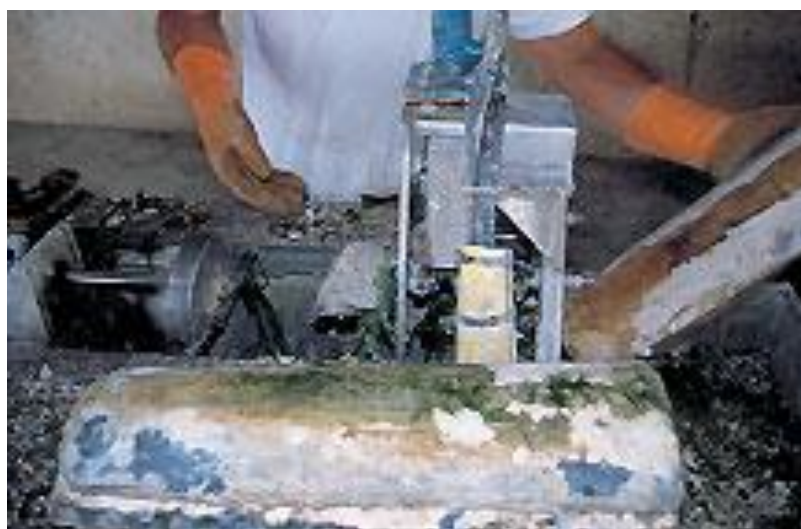
Illustration 3-4 – Détachement mécanisé des collecteurs
