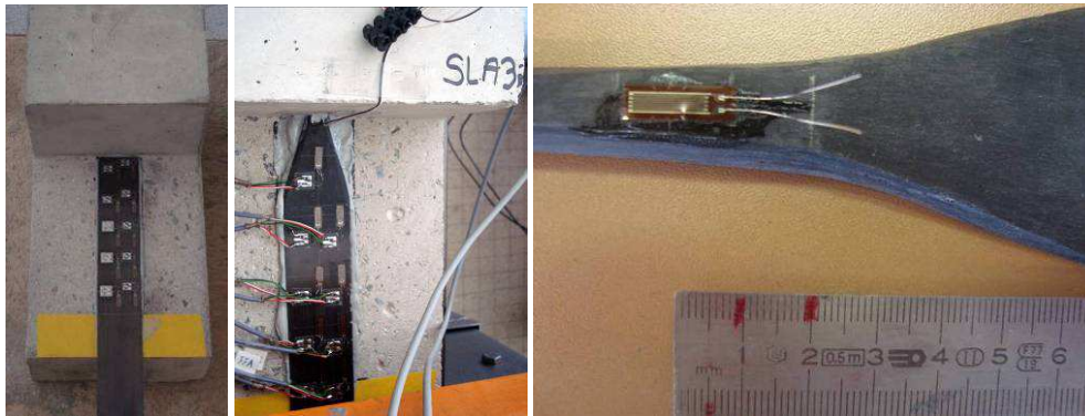
Figure A2- 3: Instrumentation mise en place sur les lamelles simples et lamelles avec ancrage.
