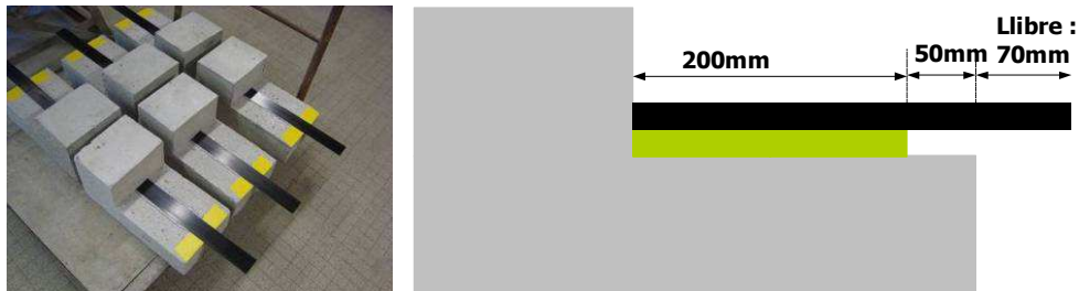
Figure 2-20: Lamelles simples collées sur les blocs en béton.
