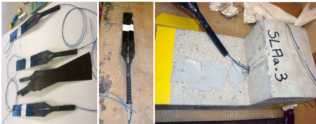
Figure 2-32 : Lamelles ancrées avec F.O. noyées dans l'ancrage et mise en place sur le bloc support en béton.
