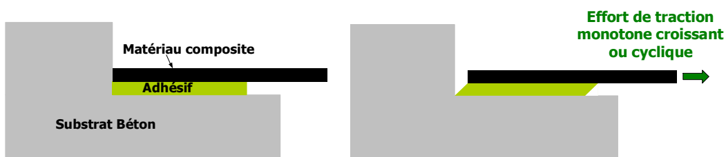
Figure 2-15 : Principe de sollicitation en cisaillement du joint adhésif consécutif à l'application d'un effort de traction au matériau composite.
