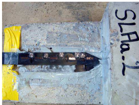
Figure 2-42 : Rupture du corps d'éprouve SLAa2.
