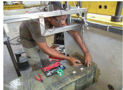
Figure 3-28 : Plan d'instrumentation (vue de dessus) et mise en place des jauges externes.
