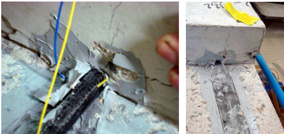
Figure A3- 9 : sortie de la partie ancrée de la lamelle et état de surface après extraction - essais SLAc3i.
