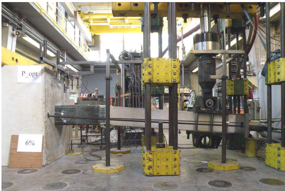
Figure 3-58 : Déformée de PCLA partiel lors de la sollicitation.
