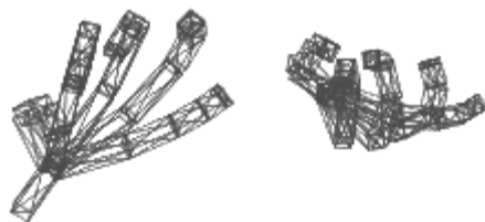
FIGURE 4.6 – Modèle 3D formant une chaîne cinématique à 15 degrés de liberté.
