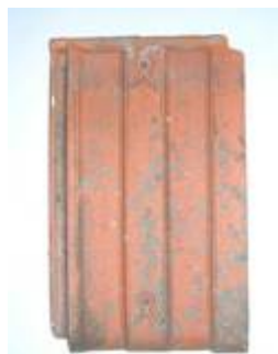
Doc 135 : tuile mécanique importée des tuileries de la Loire pour la reconstruction 853
