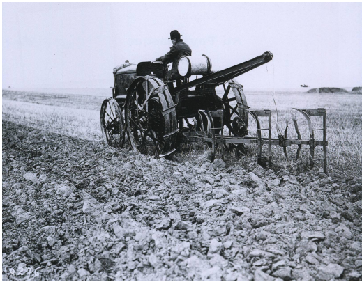
Doc 188 : tracteur « Gerbe d'or » tirant une charrue réversible à trois socs dans le Soissonnais vers 1920 976
