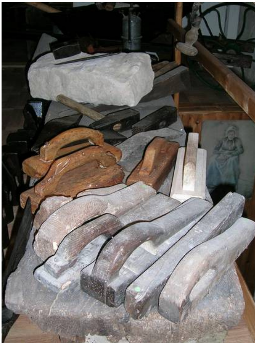
Doc 149 : banc de tailleur de pierre. Du premier plan vers le fond : 10 rabotins ou chemins de fer (bois et fer), 1 marteau taillant (fer), 1 brettüre (fer), sur la pierre : 1 tire ligne (fer) et une massette (fer), coins sous la pierre pour la relever et assurer une prise (bois), outils de l'entreprise Maroteaux-Cabaret 882
