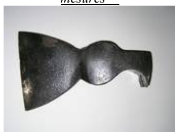
Doc 159 : hachette arrache clous de charpentier 898
