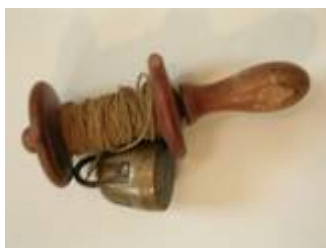
Doc 41 : fil à plomb réalisé dans un percuteur ; bois, ficelle et laiton 274
