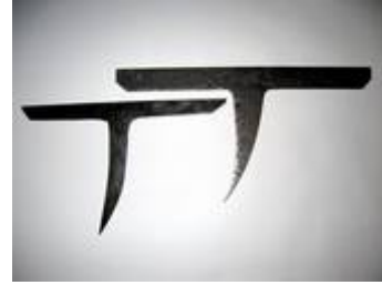
Doc 164 : enclumettes de couvreur : piquées dans un chevron, elles permettaient de retailer les ardoises 903
