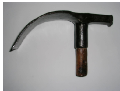
Doc 158 : herminette de charpentier : outil utilisé pour « rattraper » le bois au moment de l'assemblage 897
