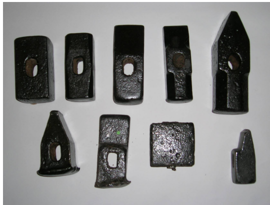
Doc 146 : ensemble de masses et massettes de carrier, entreprise maroteaux-Cabaret. On notera l'usure de certaines masses et notamment le sens de l'usure (à droite) 877
