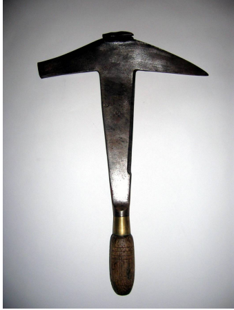
Doc 162 : hachette façon Angers de couvreur : pour retailer les ardoises sur le toit 901
