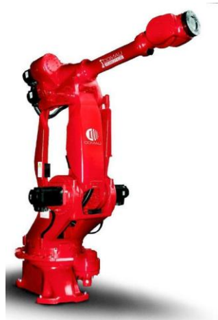
Figure 1-21: Le robot manipulateur industriel de type SMART NJ 370-2.7 à six degrés de liberté.
