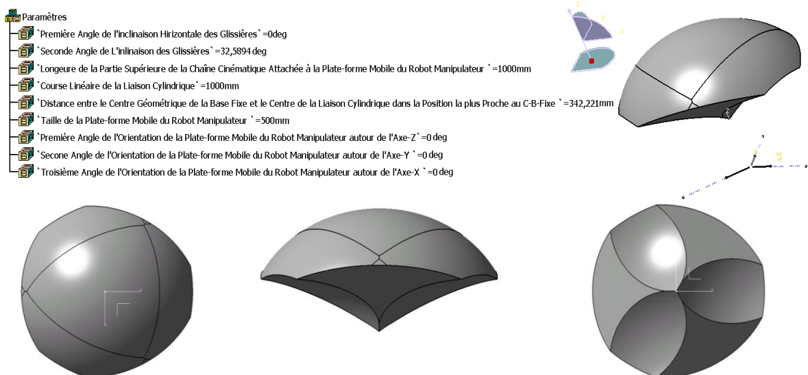
Figure 5-35: Paramètres géométriques de conception et différentes vues de l'espace de travail en orientation constante (Optimisation 1).
