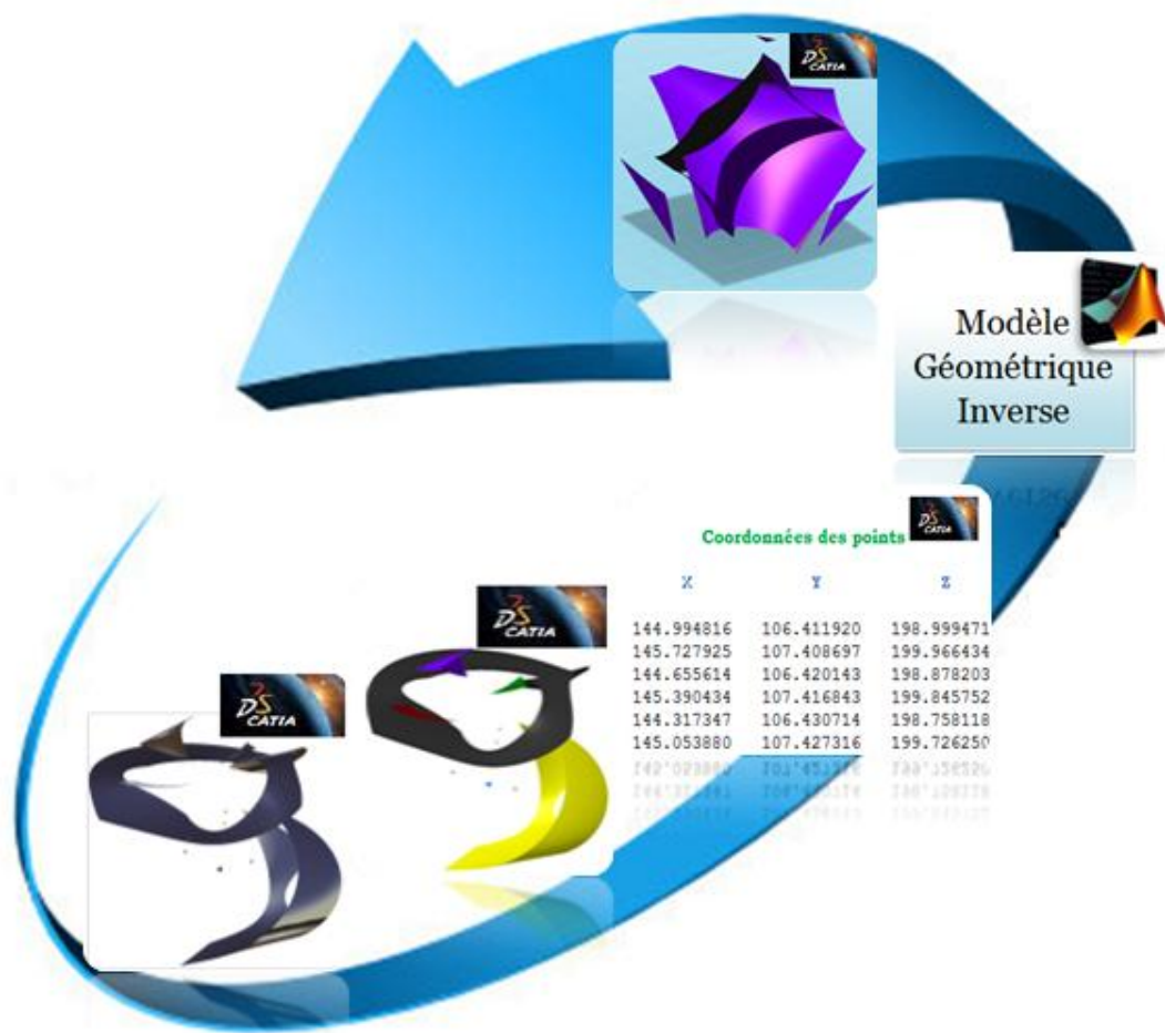
Figure 3-30: Méthodologie pour construire la surface de singularité dans l'espace articulaire.
