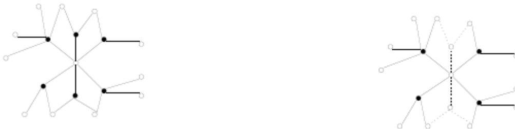
FIGURE 4.1 – Dans le premier graphique, à gauche, où tous les voisins d'un nœud retransmettent, six répétitions (les nœuds en noirs) sont nécessaires. Par contre, en utilisant la retransmission par les relais multipoints seuls (à droite), on économise deux retransmissions.
