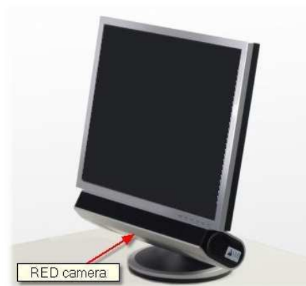
FIGURE 7.3 – L’oculomètre Iview X RED de marque SMI, monté sous son écran d’affichage dédié.
