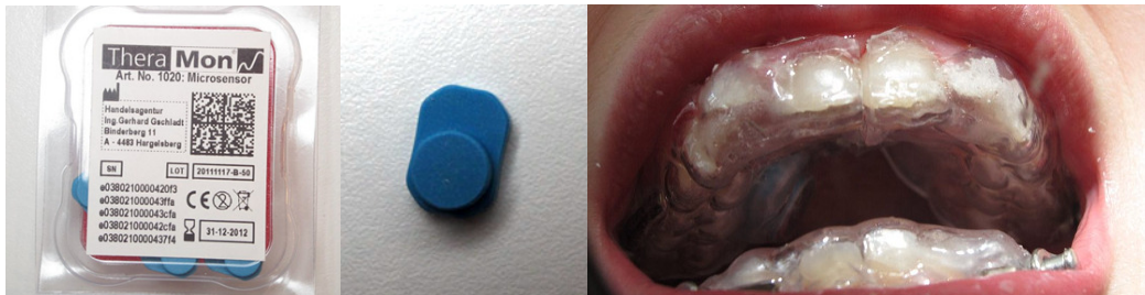
Figure 45: Puces électroniques pour évaluation de l'observance, validées pour une utilisation intrabuccale (Theramon™) a) norme CE b) gros plan (diamètre 4mm) c) illustration clinique, capteur inclus dans une bielle de Herbst
