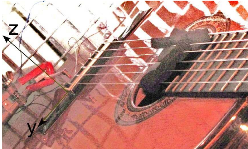
FIGURE 3.15 – Dispositif expérimental. L'axe y est défini comme celui perpendiculaire aux cordes et parallèle à la table d'harmonie. L'axe z est l'axe normal à la table d'harmonie.
