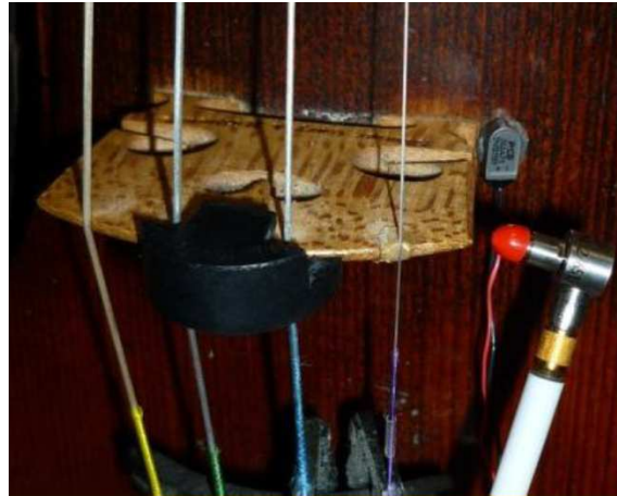
FIGURE 5.17 – Sourdine utilisée pour l'étude, mise en place sur le chevalet du violon. Sa masse est de 1.2 g.
