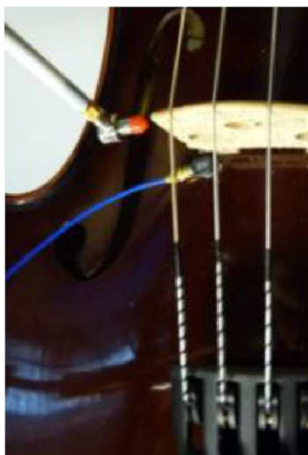
FIGURE 4.1 – Montage utilisé pour la mesure de mobilité au chevalet des violons. L'accéléromètre est placé au pied du chevalet, mesurant l'accélération transverse de la table d'harmonie, l'impact est effectué en haut du chevalet, soit latéralement (sur le côté du chevalet), soit dans la direction transverse (sur le haut du chevalet)
