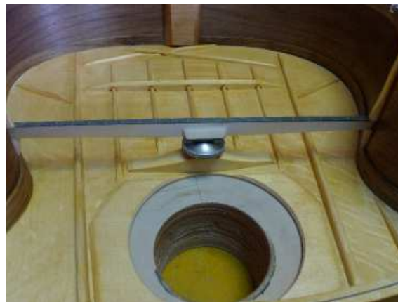
FIGURE 5.7 – Photographie de l'intérieur de la guitare de Jean-Marie Fouilleul montrant la barre réglable, ainsi que la molette permettant le réglage.
