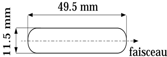
FIG. 2.4 – Géométrie de la cellule cible.
