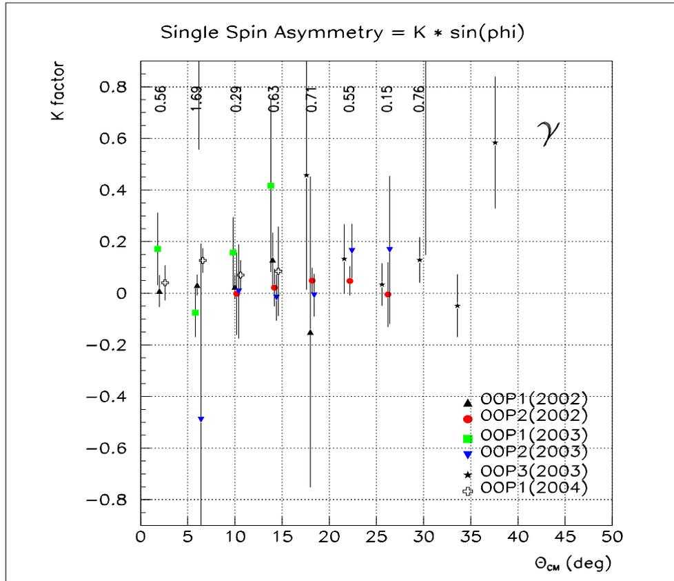
FIG. 3.14 – Le facteur  $K$  d'électroproduction de photon (et son erreur statistique) obtenu pour chaque cinématique, avec les conditions d'analyse: coupures "standard + spécifique +  $[Z_{cen}]$ " et  $M_x^2 = [-0.005, 0.005]$   $\text{GeV}^2$ . Les points dans un même intervalle en  $\theta_{cm}$  sont légèrement décalés en abscisse pour augmenter la visibilité.
