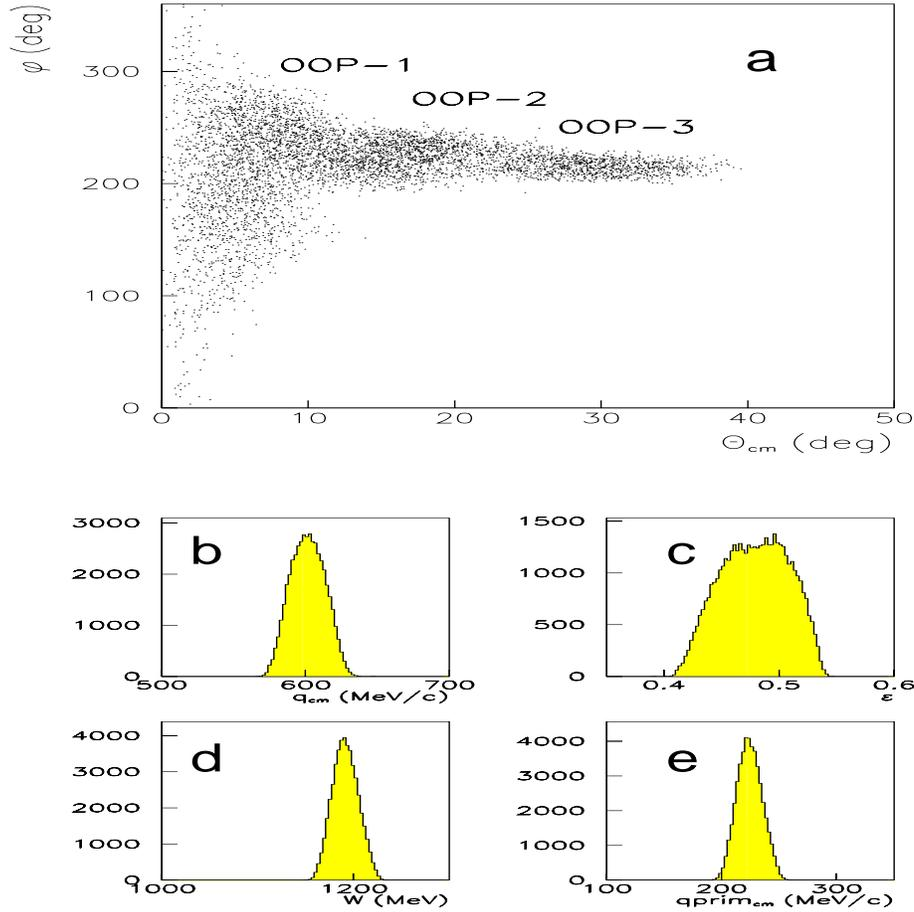
FIG. 3.11 – Spectres des variables cinématiques du processus VCS: (a) l'espace de phase  $(\phi, \theta_{cm})$ ; (b) l'impulsion du photon virtuel  $q_{cm}$ ; (c) la polarisation du photon virtuel; (d) l'énergie totale dans le centre de masse; (e) l'impulsion du photon réel  $q'_{cm}$ .
