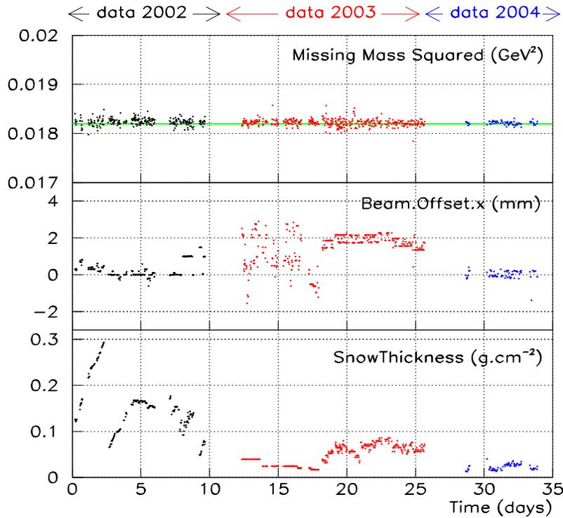
FIG. 4.3 – Calibration de la masse manquante au carré run par run dans l'analyse finale. En haut: position du pic du  $\pi^0$ . La ligne horizontale à  $M_x^2 = m_{\pi^0}^2$  est le but de cette calibration. Au milieu: Position horizontale moyenne du faisceau, ajustée en fonction du temps. En bas: Ajustement de la couche de givre (densité de givre  $\times$  épaisseur de givre) en fonction du temps.
