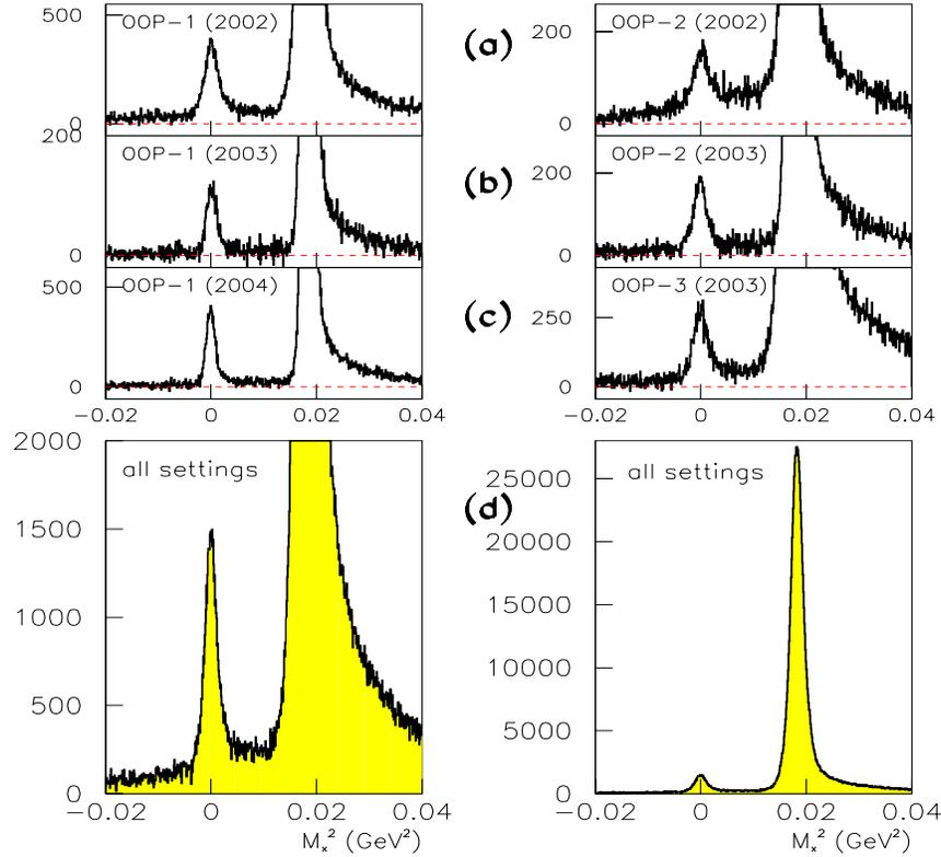
FIG. 3.10 – (a, b, c): spectres de la masse manquante au carré par réglage cinématique, focalisés sur le pic d'électroproduction de photon. (d): spectre de  $M_x^2$  (à droite) pour la somme de tous les réglages et un zoom sur le pic  $\gamma$  (à gauche). Ces spectres sont obtenus avec les coupures : standard + spécifique +  $[Z_{cen}]$ .
