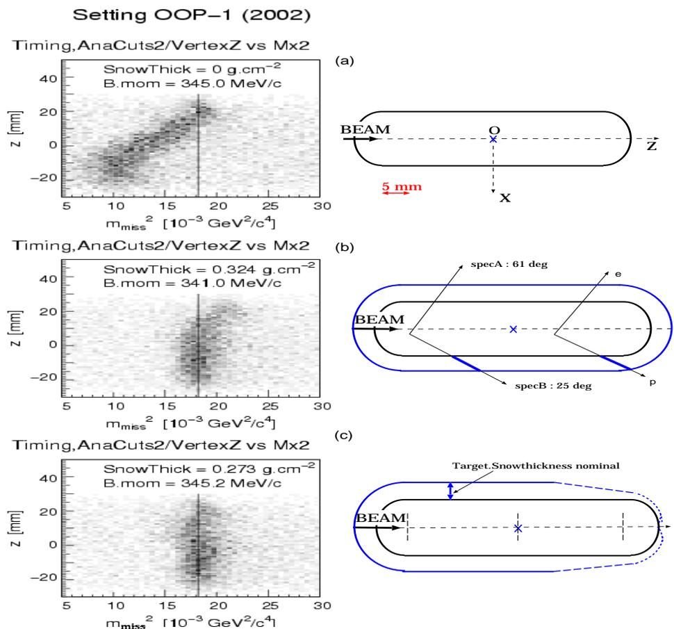
FIG. 3.1 – Effet du givre sur le spectre de la masse manquante au carré ( $M_x^2$ ) dans la région du pic  $\pi^0$  : (a) ne considère pas de givre, et l'impulsion centrale dans le spectromètre B est à sa valeur nominale; (b) est le meilleur ajustement de ( $M_x^2$ ) pour le modèle de givre en couche uniforme; l'impulsion centrale a été réduite de plus de 1%; (c) est l'ajustement de ( $M_x^2$ ) pour le modèle de givre en couche non-uniforme, l'impulsion centrale a été augmentée d'environ 0.06%.
