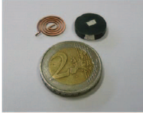
FIGURE 5.4.1: Photographie de l'inductance cofrittée par le procédé Spark Plasma Sintering à 800 °C pendant 5 min, sous argon et sous une pression uniaxiale de 50 MPa.
