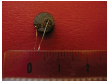
FIGURE 5.2.4: Photographie d'une inductance à base d'une spirale planaire circulaire en fil de cuivre.
