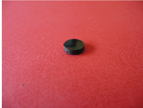
FIGURE 4.5.2: Photographie de la pièce cofrittée à 800 °C pendant 5 min sous argon et sous une pression uniaxiale de 50 MPa.
