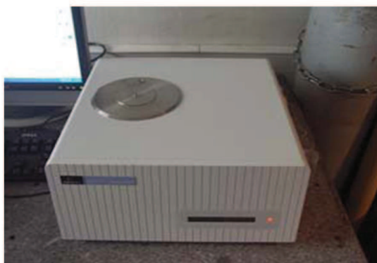
FIGURE 2.2.3: Photographie de l'appareil d'analyse thermogravimétrique (ATG).
