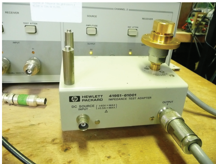
FIGURE 2.2.7: Photographie du banc de mesure de la perméabilité complexe à haute fréquence.
