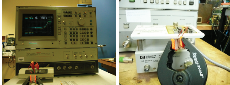
FIGURE 2.2.5: Photographie du banc de mesure de la permittivité diélectrique : basse fréquence (à gauche), et haute fréquence (à droite).
