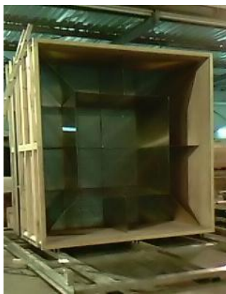
(a) Photographie du tronçon contenant la forme convergente
