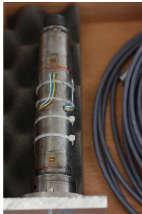
Figure 3.17 – Barreau instrumenté et jauges de déformation
