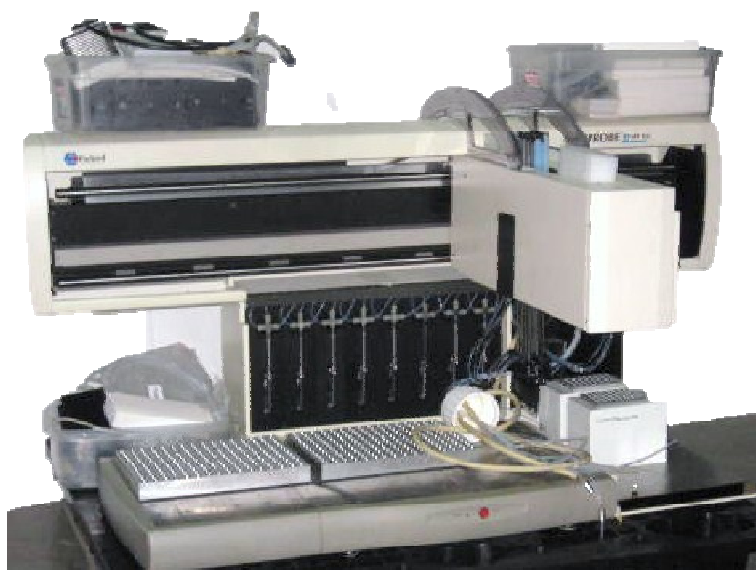
Figure 27 : Robot Multiprobe II utilisé pour les analyses des biomarqueurs moléculaires. Ce robot « pipetteur » permet de transférer des liquides d'un contenant vers un autre.
