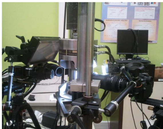
FIGURE 3.23 : Montage double {monovision + stéréovision}.
