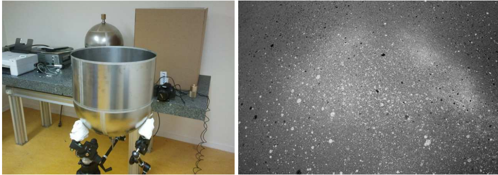
FIGURE 2.17 : Préparation du montage de stéréovision pour le fond du demi-liner – image du fond du demi-liner (images prises avec deux Canon EOS 40D).
