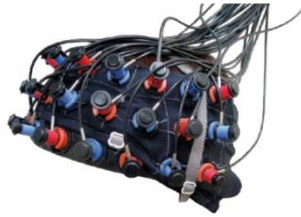
Figure 19 : Casque de spectroscopie proche infrarouge. Source : http://www.nirsforum.com/
