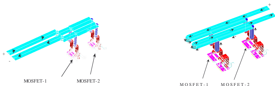
(a) Structure conduisant à des courants déséquilibrés.
