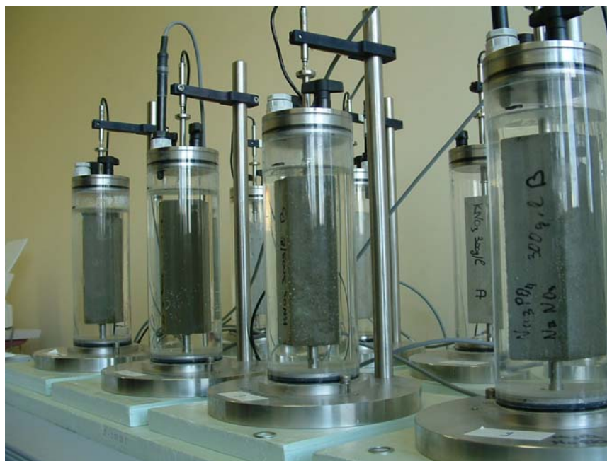
Figure 72 : Photographie représentant le dispositif de suivi des dimensions en continu d'éprouvettes de mortiers.
