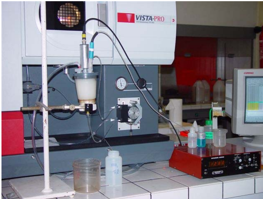
Figure 85 : Photographie du montage de la cellule de dissolution couplé au spectromètre ICP-OES
