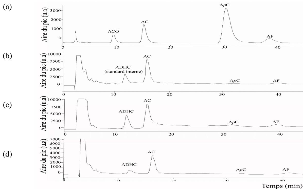
**Figure 60 : Chromatogrammes des Cafés expérimentaux, avec hydrolyse alcaline** standards d'acides phénoliques dans la phase mobile ; (b) café Carte Noire à 20g/L en présence d'acide dihydrocaféique (standard interne) ; (c) café atomisé à 20g/L en présence d'acide dihydrocaféique (standard interne) ; (d) café au lait atomisé à 15g/L en présence d'acide dihydrocaféique (standard interne) ; u.a. : unités arbitraires.
