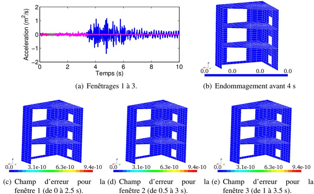
**Figure E.38:** Résultats des fenêtres 1 à 3, correspondant à la localisation de l'endommagement illustré en figure E.38(b).
