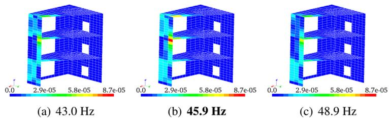
**Figure E.18:** Champs d'erreur pour les fréquences du troisième pic.
