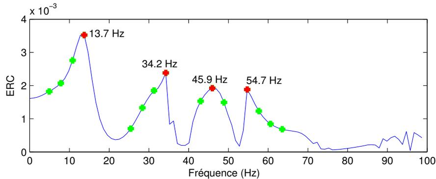
**Figure E.15:** Défaut étudié et spectre d'erreur. En rouge les fréquences qu'on envisage de prendre en compte dans le calcul. En vert celles pour lesquelles on vérifie l'approximation.
