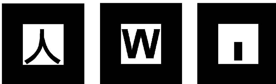
FIG. 5.8 – Exemple de marqueurs détectés dans des images vidéo par l'ARToolkit. Les points d'intérêts sont les 4 coins du carré et le motif central sert à les identifier quand plusieurs marqueurs sont présents dans la même image.
