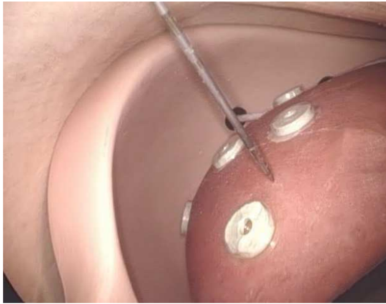
FIG. 8.4 – Vérification par vision endoscopique de la qualité du positionnement de l'aiguille dans la cible. Le déplacement de la caméra dans le mannequin étant extrêmement limité: un seul marqueur était suffisamment visible pour permettre une vérification pertinente.
