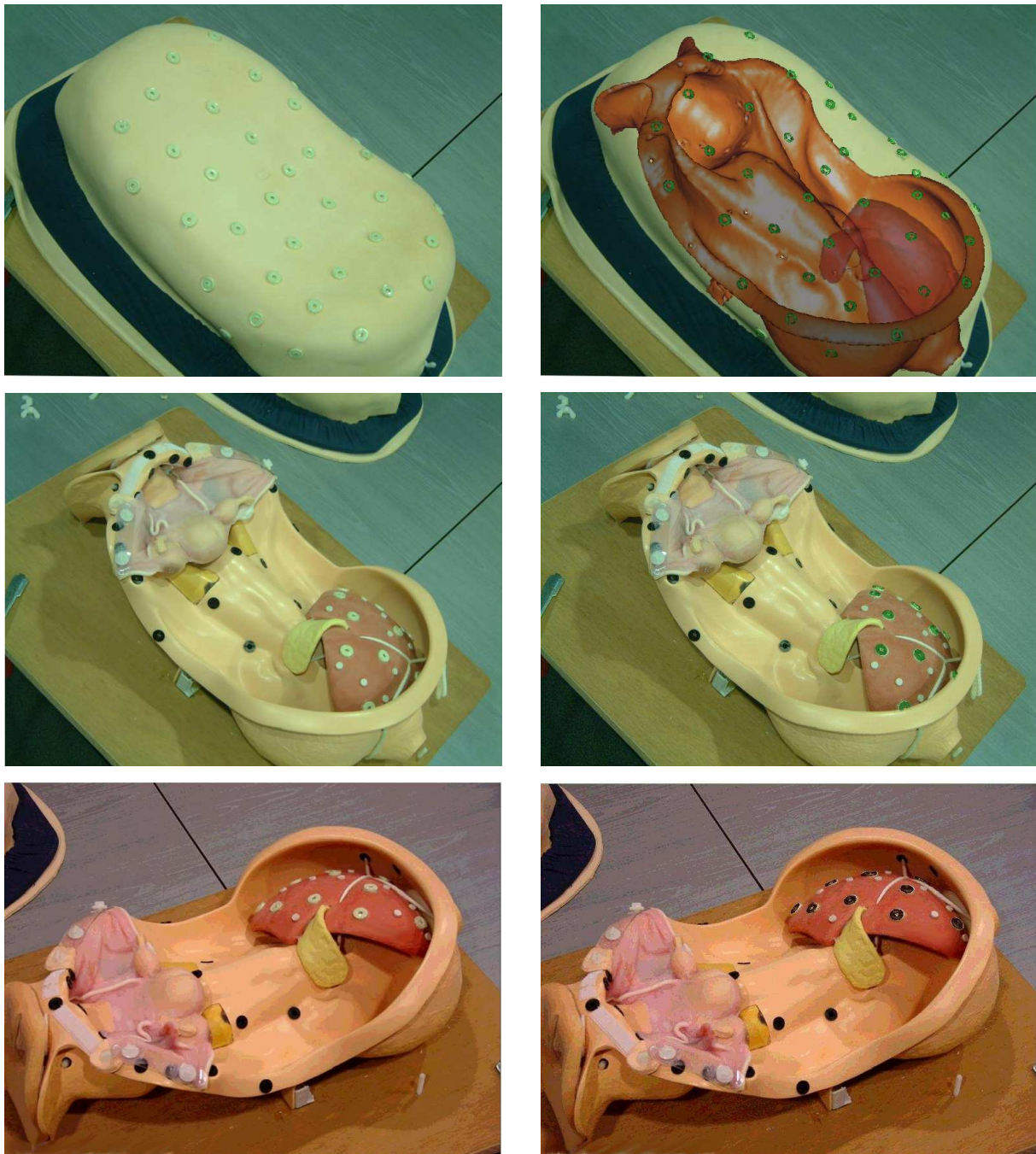
FIG. 4.5 – Validation visuelle de la précision du recalage sur notre mannequin: le recalage a été réalisé avec 2 caméras. L'image en haut à gauche montre le mannequin avec les marqueurs radio-opaques. L'image en haut à droite est un exemple de vue augmentée dont pourrait bénéficier le praticien, c'est à dire la superposition sur l'image vidéo des reconstructions 3D des marqueurs et des parties internes (structure en plastique et foie synthétique) après recalage. Pour vérifier visuellement la qualité du recalage sur le foie, nous avons enlevé la peau et superposé la reconstruction des marqueurs sur le foie. Les images de gauche au milieu et en bas montrent le mannequin sans sa peau selon les 2 points de vue des caméras utilisées. Sur les 2 images correspondantes à leur droite, nous pouvons observer la qualité de la superposition des marqueurs virtuels sur le foie.
