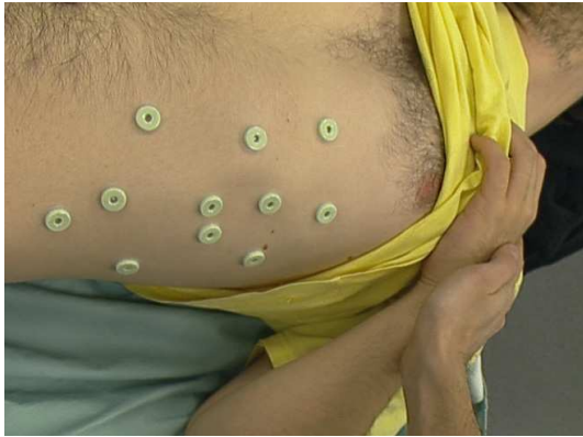
FIG. 6.2 – La surface d'un marqueur dans l'image vidéo dépend de son inclinaison par rapport à l'axe optique de la caméra. Les marqueurs étant suffisamment éloignés de la caméra, nous pouvons approximer la transformation projective par une projection orthogonale sur le plan image de la caméra. La projection d'un disque C de rayon R résulte donc en une ellipse \Gamma de demi-axes R et R \cdot \cos \theta . Le rapport entre les surfaces de C et \Gamma vaut donc \cos \theta . Dans nos conditions \theta n'excédera pas 60^\circ , un choix conservateur pour \alpha et 1/\alpha est donc \cos 60^\circ = 0.5 et \frac{1}{\cos 60^\circ} = 2.0 .
