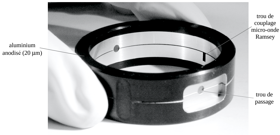
FIG. 2.13: Photo de l'anneau qui ferme la cavité (voir texte pour détails).
