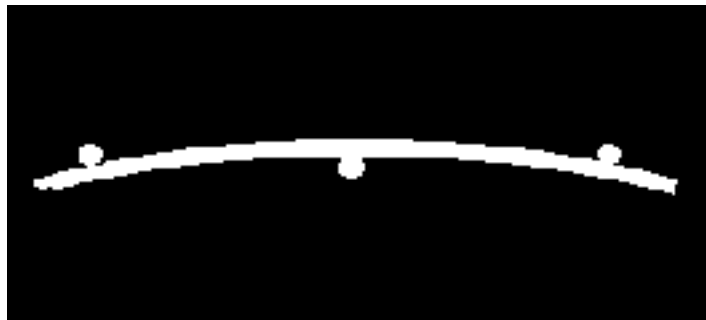
Fig. III.3: Schéma d'un bâtonnet fléchi dans le plan de l'eau par trois points d'appui.
