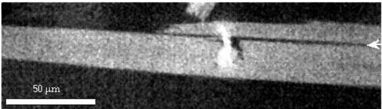
Fig. IV.26: Fusion thermodynamique d'un cristal maintenu fléchi dans le plan de l'eau. Ici, la fusion est conduite par l'élévation de la température de la monocouche. (La flèche à l'extrémité droite de la photo indique une ligne sombre qui correspond à du liquide qui sépare le cristal étudié d'un autre cristal libre dans la monocouche.)
