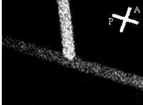
Fig. IV.21: Observation d'un joint de grains par microscopie de fluorescence avec lumière polarisée. Les bâtonnets qui ne sont ni parallèles à la direction de polarisation de l'analyseur (A) et à celle du polariseur (P) sont lumineux et les plus lumineux sont à 45^\circ des deux directions.
