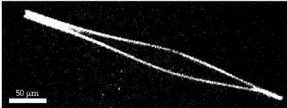
Fig. IV.38: Seule la partie centrale du cristal a été illuminée ce qui explique que ses extrémités n'aient pas fondu.
