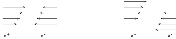
FIG. 4.5 – Le phénomène de dispersion verticale pour D_{e^+}^* = -D_{e^-}^* : la longueur des flèches représente l'impulsion d'une particule. À gauche: \delta y = 0 ; à droite: \delta y \neq 0
