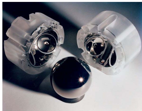
Figure 8. 4 : photographie du rotor du gyroscope de Gravity-Probe B.
