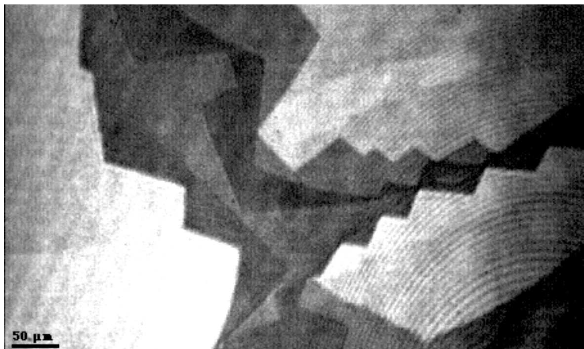
figure II.13 : image d'un film anisotrope (décrit au chapitre V), réalisée en polarisation p et avec un analyseur sur le chemin de la lumière réfléchie. Les différents niveaux de gris correspondent à différentes orientations des axes du milieu.
