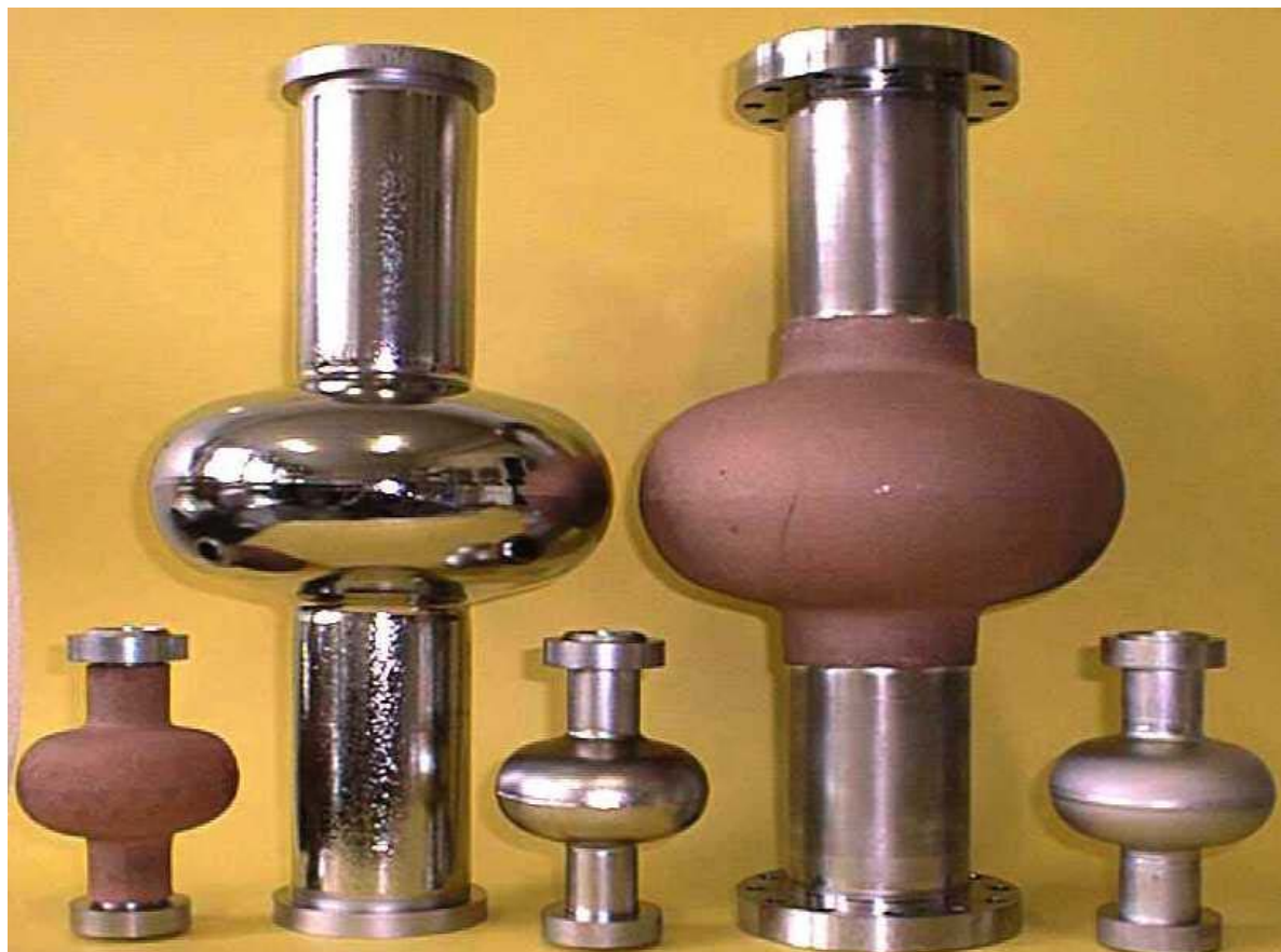
FIG. 5.44 – Cavités 3 GHz (petite) et 1,3 GHz (grande) avant et après cuivrage
