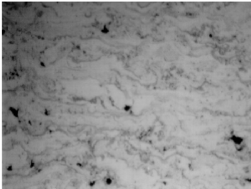
FIG. 5.6 – Microstructure dans l'épaisseur d'un dépôt de cuivre HVOF
