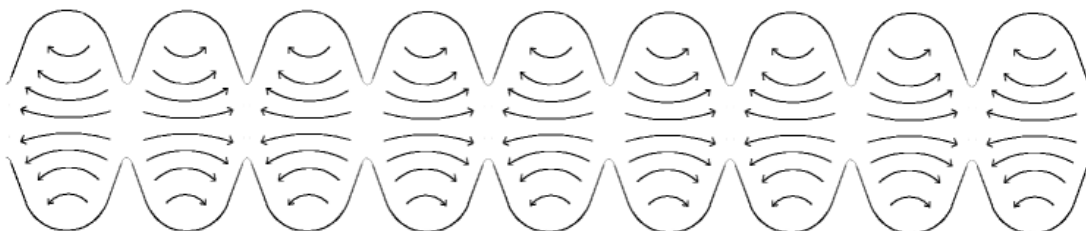
FIG. 2.14 – Lignes de champ électrique dans les 9 cellules
