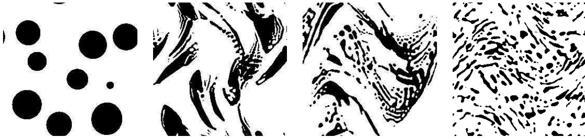
Fig. 3.10: Évolution d'une assemblée de (grosses) gouttes dans un écoulement chaotique, \alpha = 0.4 , pour des temps t = 0, 0.65, 1.50, 11.8 , de gauche à droite. La dernière configuration est typique de l'état stationnaire dynamique atteint.
