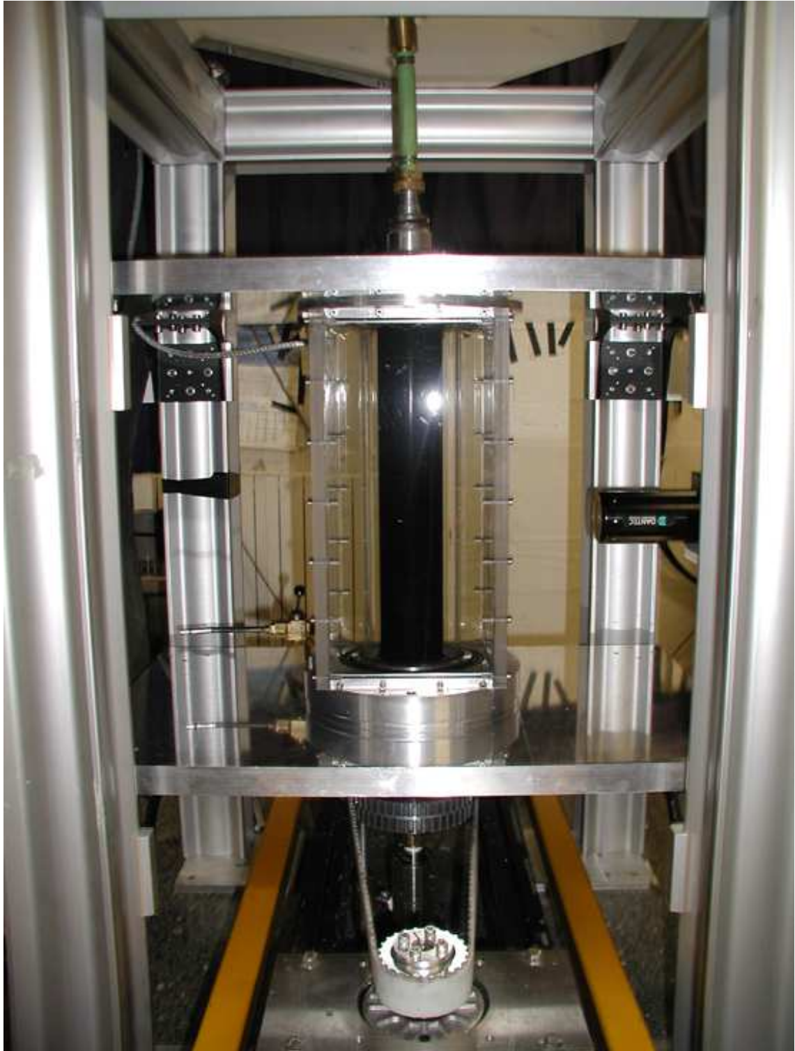
Fig. 4.1: Dispositif expérimental en configuration LDV. La cuve rectangulaire autour des cylindres est emplie d'eau à température constante. Le cylindre interne en aluminium est recouvert d'un revêtement noir pour éviter la réflexion des faisceaux laser (la tête laser est visible à droite). L'ensemble est monté entre deux plaques d'aluminium fixées sur un châssis micro-control solidaire du marbre. Un des deux moteurs est visible en bas de l'image : ils sont montés sur un châssis indépendant sans contact avec le marbre pour minimiser la transmission des vibrations.
