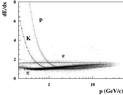
**Figure 3.11:** Perte d'énergie par ionisation en fonction de l'impulsion, pour différents types de particules. La normalisation est telle que les particules au minimum d'ionisation ont  $dE/dx=1$ . Les courbes superposées sont les prédictions théoriques.
