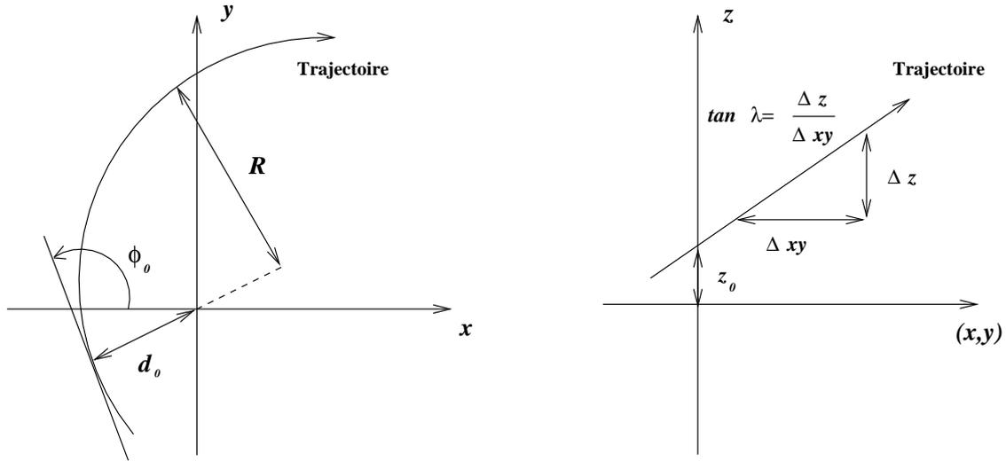
**Figure 3.9:** Définition des paramètres de l'hélice associée à la trajectoire d'une particule chargée.
