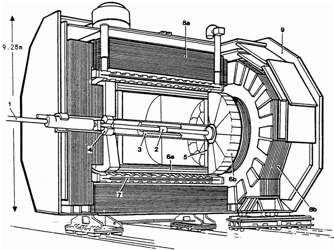
**Figure 3.3:** Coupe du détecteur ALEPH (1 : tube à vide, 2 : VDET, 3 : ITC, 4 : moniteurs de luminosité, 5 : TPC, 6 : ECAL (a : baril, b : bouchons), 7 : bobine supraconductrice, 8 : HCAL (a : baril, b : bouchons), 9 : chambres à muons).
