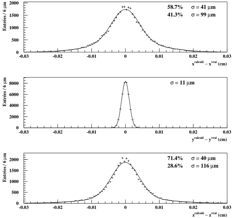
**Figure 4.5:** Distribution de la différence entre la position calculée et la position vraie du vertex primaire en  $x$ ,  $y$  et  $z$ , dans le Monte-Carlo (croix). Les courbes superposées sont le résultat de l'ajustement par des gaussiennes (deux en  $x$  et  $z$  et une en  $y$ ), dont les fractions et les écarts types respectifs sont indiqués.
