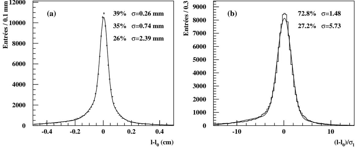
**Figure 4.6:** Avant les coupures du paragraphe 4.4; (a) résolution sur la longueur de vol, ajustée par la somme de trois gaussiennes; (b) résolution normalisée sur la longueur de vol ajustée par la somme de deux gaussiennes. Les fractions et les écarts types des gaussiennes sont indiqués (à comparer avec fig. 4.10 et fig. 4.13).
