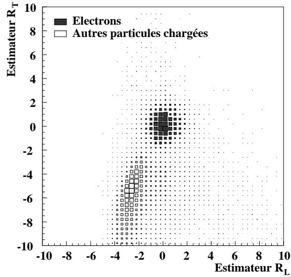
**Figure 3.14:** Distribution de l'estimateur transverse  $R_T$  en fonction de l'estimateur longitudinal  $R_L$  pour des électrons et pour les autres particules chargées d'impulsion supérieure à 1 GeV/c présentes dans ALEPH, dans une simulation.
