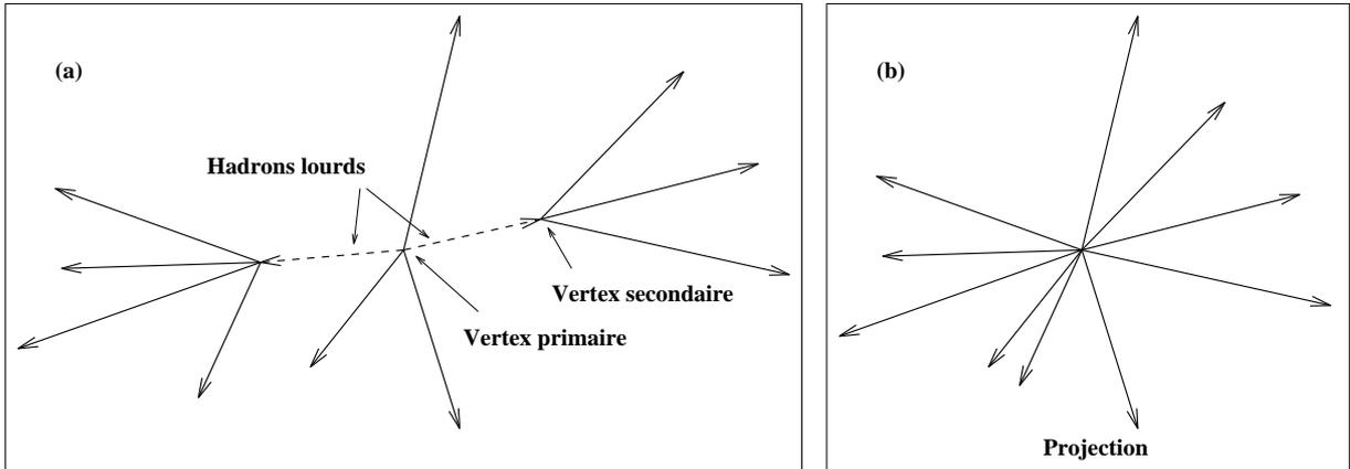
**Figure 4.4:** Schéma de principe de la recherche du vertex primaire. (a) Exemple d'événement avec désintégrations de hadrons lourds. (b) Après projection le long de la direction des hadrons lourds, toutes les particules semblent provenir du même point.
