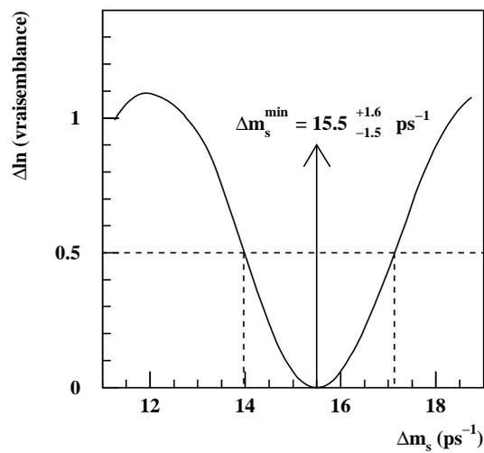
Figure 6.5:  $\Delta \ln \mathcal{L}$  en fonction de  $\Delta m_s$ , agrandissement de la figure 6.4, dans la région du minimum global. La valeur préférée de  $\Delta m_s$  est  $15.5^{+1.6}_{-1.5} \text{ ps}^{-1}$ , mais la profondeur du minimum n'est que de 1.16 unités, soit  $1.5\sigma$ .
