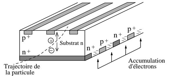
Figure 3.6: Détail de fonctionnement du VDET.
