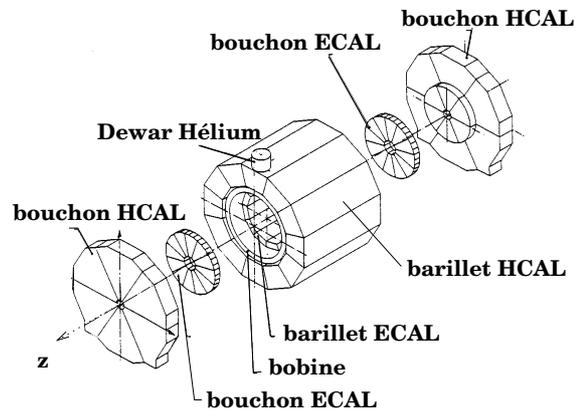
**Figure 3.10:** Les calorimètres électromagnétique (ECAL) et hadronique (HCAL).
