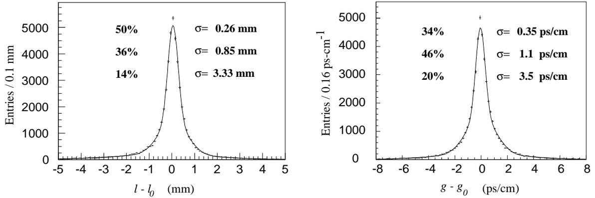
**Figure 4.12:** Résolution sur la longueur de vol et sur le terme de poussée, dans l'analyse [59] (à comparer avec fig. 4.13). Les histogrammes sont ajustés par la somme de trois gaussiennes dont les fractions et les écarts types sont indiqués.
