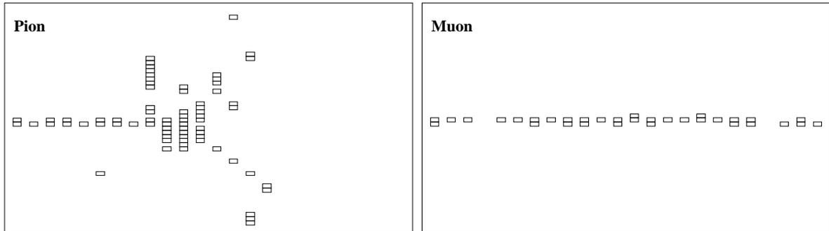
**Figure 3.15:** Exemple d'images données par les tubes à *streamer* du HCAL pour un pion et un muon de 10 GeV.
