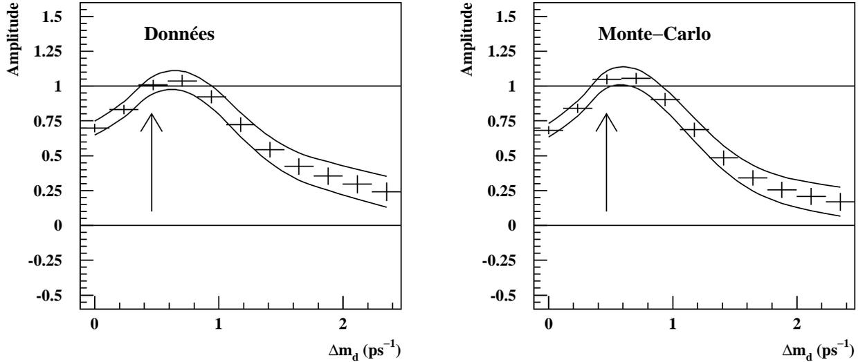
**Figure 6.13:** Amplitude d'oscillation des  $B_d^0$  mesurée en fonction de  $\Delta m_d$  dans (a) les données et (b) le Monte-Carlo. Les barres d'erreur représentent l'incertitude statistique à  $1\sigma$  et les courbes en trait plein les contours d'exclusion à 95% CL (sans les incertitudes systématiques). Les flèches indiquent les valeurs  $\Delta m_d$  ajustées par la méthode du maximum de vraisemblance.
