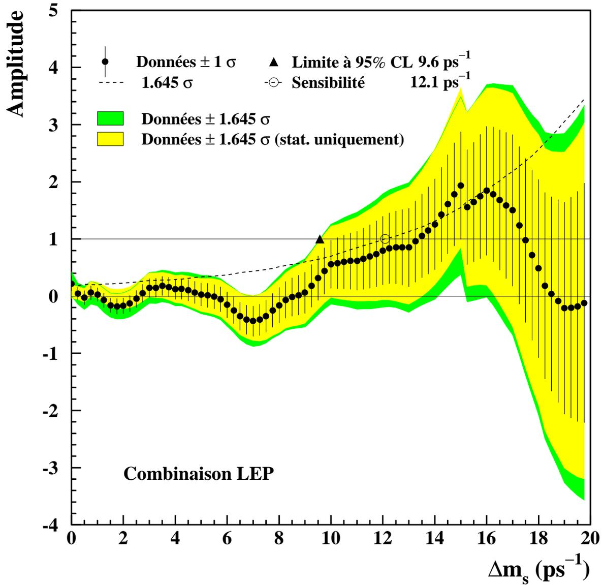
**Figure 6.17:** Amplitude d'oscillation des  $B_s^0$  mesurée en fonction de  $\Delta m_s$ , dans les données, pour la combinaison LEP. Les discontinuités du graphe sont dues au fait que certaines expériences ne fournissent pas les valeurs de l'amplitude jusqu'à  $\Delta m_s = 20 \text{ ps}^{-1}$ .
