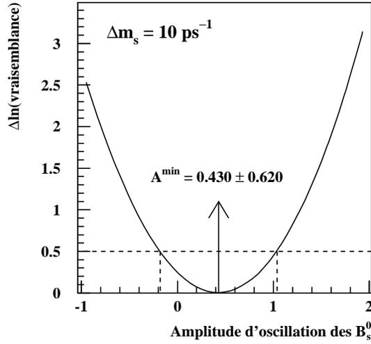
**Figure 6.6:**  $\Delta \ln \mathcal{L}$  en fonction de l'amplitude d'oscillation des  $B_s^0$ , dans les données, pour  $\Delta m_s = 10 \text{ ps}^{-1}$ . Les lignes discontinues verticales indiquent les valeurs de l'amplitude lorsque  $\Delta \ln \mathcal{L} = \Delta \ln \mathcal{L}^{\min} + 0.5$  et définissent l'intervalle d'erreur standard sur la mesure de l'amplitude.
