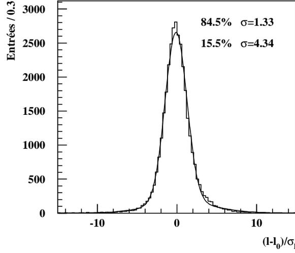
**Figure 4.10:** Résolution normalisée sur la longueur de vol, après toutes les coupures (à comparer avec fig. 4.6). L’histogramme est ajusté par la somme de deux gaussiennes dont les fractions et les écarts types sont indiqués.
