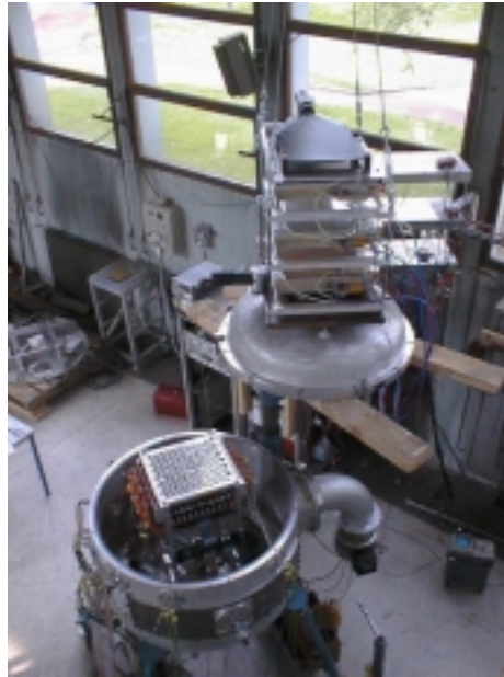
FIG. 2.12: Photo du dispositif expérimental du mini-RICH installé dans le Hall B de l'ISN dans sa configuration "détection en rayons cosmiques".
