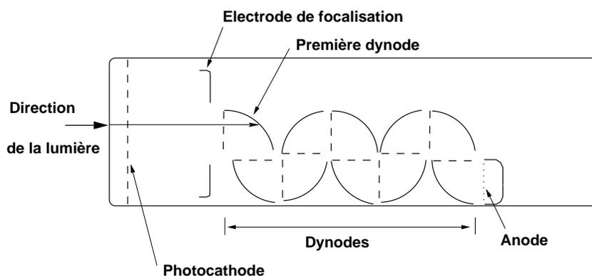
Figure A.1 : Schéma de principe d'un photomultiplicateur.
