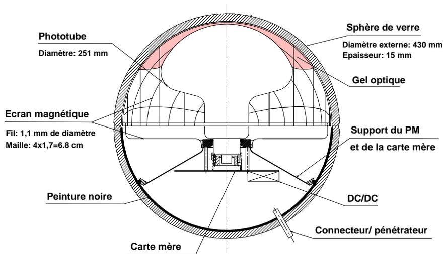
Figure 3.2 : Coupe schématique du module optique
