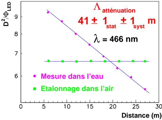
Figure 3.17 : Mesure de la longueur d'atténuation.  $D$  est la distance entre la source de lumière et le photomultiplicateur et  $\Phi_{LED}$  le flux de lumière nécessaire pour maintenir un signal constant sur le photomultiplicateur.
