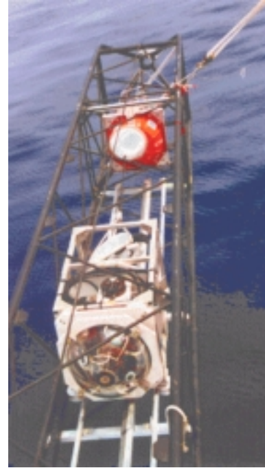
Figure 3.16 : Vue de la structure rigide de 33 m utilisée pour la première mesure de la longueur d'atténuation. Le chariot mobile et le photomultiplicateur de 8" sont visibles.
