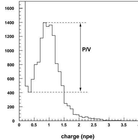
Figure 3.4 : Spectre en amplitude d'un photomultiplicateur.
