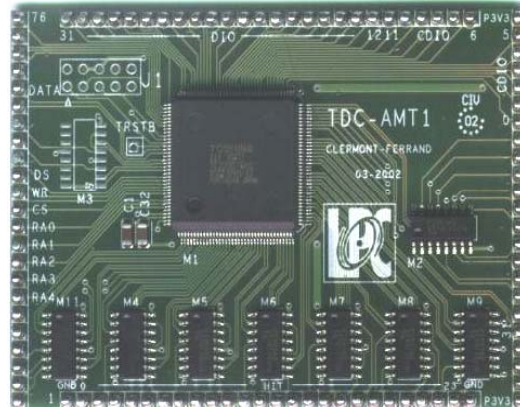
Figure 8-13 Photo de la carte fille supportant le TDC-AMT1.
