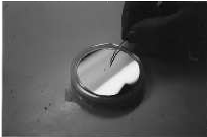
FIG. 2.2: Dépôt d'une goutte de cristal liquide sur une pastille de silicium à l'aide d'un fil métallique fin.
