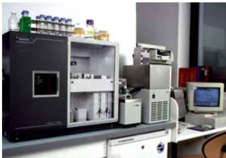
Figure A.1. Photographie d'un appareil Biacore 2000 utilisé à l'Institut Curie pour mesurer les interactions moléculaires entre plusieurs protéines ou entre des protéines et différentes séquences d'ADN (D'après Institut Curie [3])
