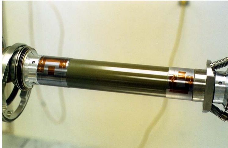
FIG. 2.35 – Vue des points de référence pour l'échelle longitudinale
