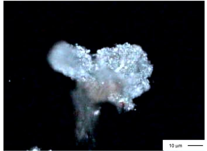
**Photo k et k'** : P-O en lumière naturelle transmise (k), la texture granuleuse en lumière naturelle incidente (k') est caractéristique des MO provenant de pneumatiques et de résidus carbonés de moteur à combustion d'automobile (photos palynofaciès, trappe à 46m, octobre 1998)
