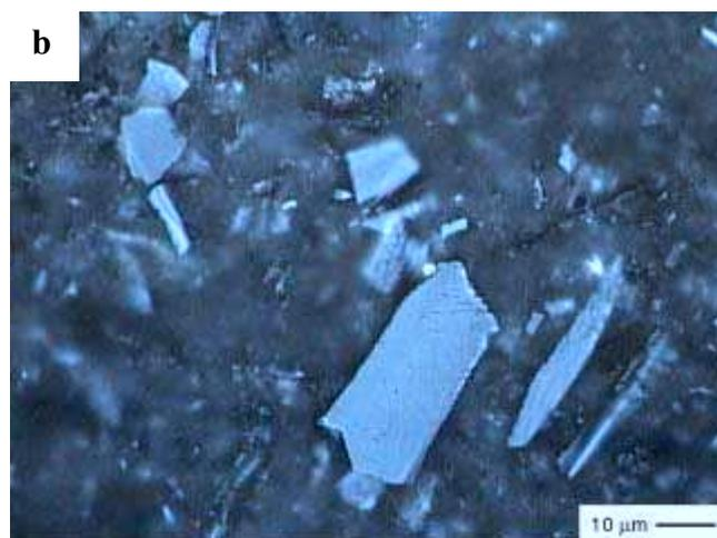
**Photo 22** : Particule Homogène Grisâtre (PH-G) observée dans un sol (a) et provenant de résidus de feux de bois (b). La photo (b) montre que les résidus organiques de feux de bois ne sont pas exclusivement des particules de type fusinite et pyrofusinite (**Photo 25-27**).
