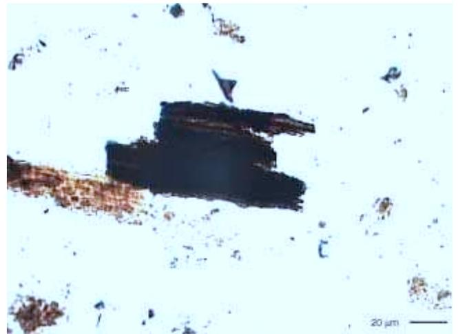
**Photo 13** : Exemple de pyrofusinite en lumière naturelle transmise. On remarquera que la fine épaisseur de la particule permet à la lumière de traverser et laisse apparaître les structures végétales originelles. Cette particularité permet de les distinguer des LC-O.
