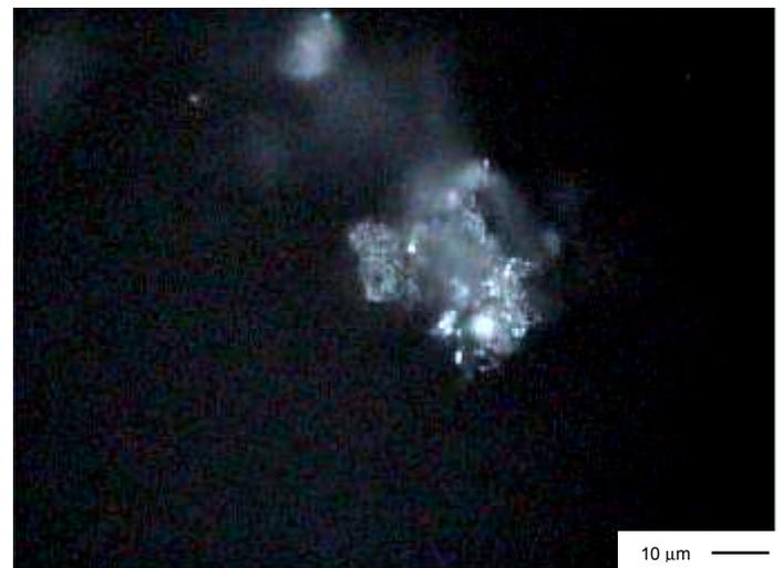
**Photo l et l'** : P-O, en lumière naturelle transmise (m), la forme de cette particule peut être confondue avec LC-O (chap.II), mais sa texture granuleuse en lumière naturelle incidente (m') est caractéristique des MO provenant de pneumatiques et de résidus carbonés de moteur à combustion d'automobile (photos palynofaciès, trappe à 46m, octobre 1998)
