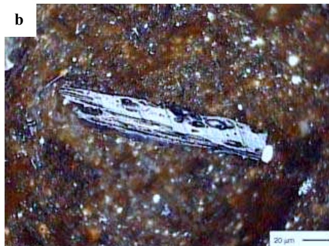
**Photo 25** : Particules de fusinite de feux de bois (a) et de pyrofusinite observées dans un sol. Dans les deux cas, on observe des structures végétales originelles, la pyrofusinite (b) présente en plus des vacuoles de dévolatilisation. Ces deux types de particule ont été regroupés sous le terme de Particule avec Structure Végétale encore visible (PSV).
