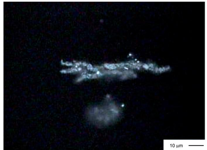
**Photo l et l'** : P-O, en lumière naturelle transmise (l), la forme de cette particule peut être confondue avec des débris de feux (pyrofusinite), mais sa texture granuleuse en lumière naturelle incidente (l') est caractéristique des MO provenant de pneumatiques et de résidus carbonés de moteur à combustion d'automobile (photos palynofaciès, trappe à 46m, octobre 1998)
