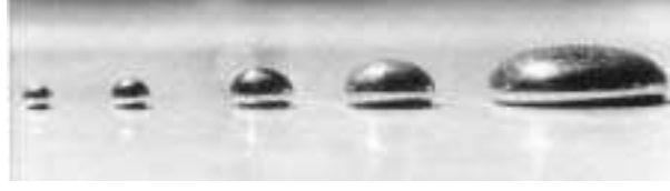
FIG. 5.3 – Gouttes de mercure de tailles croissantes déposées sur une surface horizontale. Le passage d’une forme de goutte relativement sphérique à des formes aplaties traduit le rôle prépondérant de la gravité aux échelles grandes devant la longueur capillaire l_C . La figure est tirée de la référence [3].
