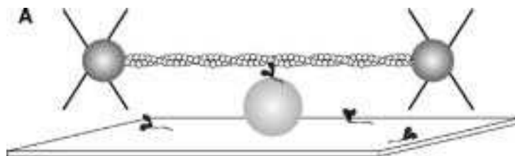
FIG. 2.6 – Géométrie expérimentale utilisée par Finer et al. [74, 75] pour étudier l'interaction d'une molécule unique de myosine avec un filament d'actine. Le filament est attaché à chaque bout à une bille piégée. Les pièges optiques permettent d'étirer le filament d'actine et de l'approcher d'une bille de silice recouverte partiellement de molécules de myosine.
