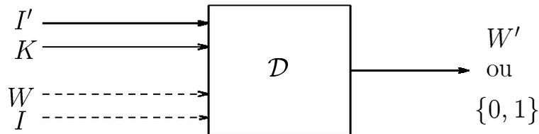
FIG. 1.3 – Schéma général du processus de détection d'une marque.  $I'$  est l'image test,  $K$  la clef privée,  $W$  la watermarque,  $I$  est l'image originale. Le résultat de la détection  $\mathcal{D}$  peut être une marque ou une décision
