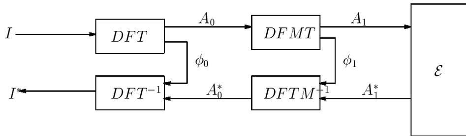
FIG. 2.2 – Schéma du tatouage dans le domaine d'invariance. La  $DFT$  est la transformée de Fourier discrète, la  $DFMT$  celle de Fourier-Mellin. Les signaux  $A_i$  représentent les amplitudes,  $\phi_i$  les phases des transformées de l'image.
