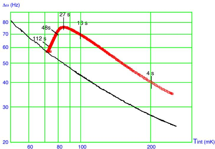
FIG. 4.9 – *Effet de la polarisation: Largeur du pic de résonance en fonction de la température lue par le thermomètre intérieur. La courbe continue a été mesurée à l'équilibre. Les carrés représentent des données mesurées pendant une fusion rapide. Les indices sur cette courbe indiquent le temps écoulé depuis le début de la fusion.*
