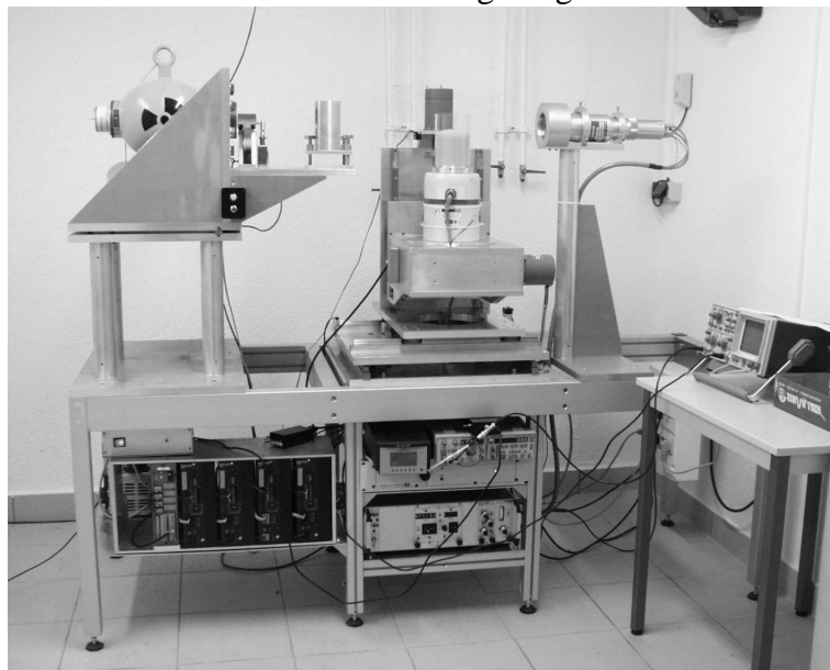
FIG. 4.1 – Schéma de principe et photographie du dispositif. Sur la photographie, on repère en particulier la source de Césium en haut à gauche et le scintillateur qui lui fait face à droite. Intercalé dans le faisceau, le récipient rempli de billes est fixé sur le pot vibrant lui-même arrimé au banc de guidage.
